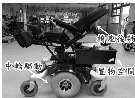
圖二 中輪驅動型電動輪椅具置物空間及椅座後躺功能
