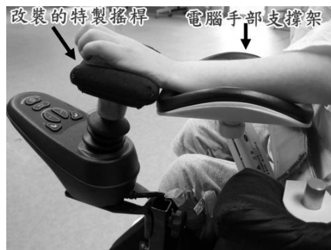
圖六 改裝後的特製搖桿與電腦手部支撐架
